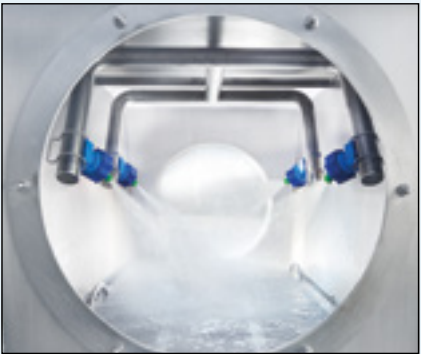
Dispositif de nettoyage en fonctionnement
